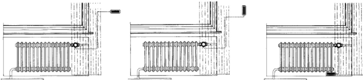
Рис. 4. Установка Thera-4 Classic с выносным датчиком
