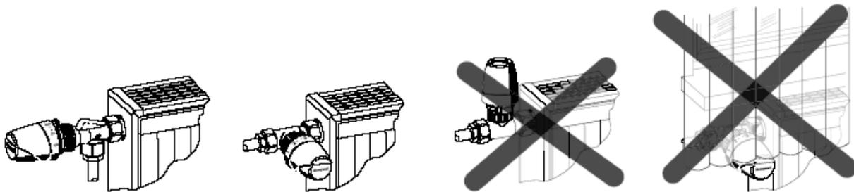
Рис. 3. Установка Thera-4 Classic с встроенным датчиком
